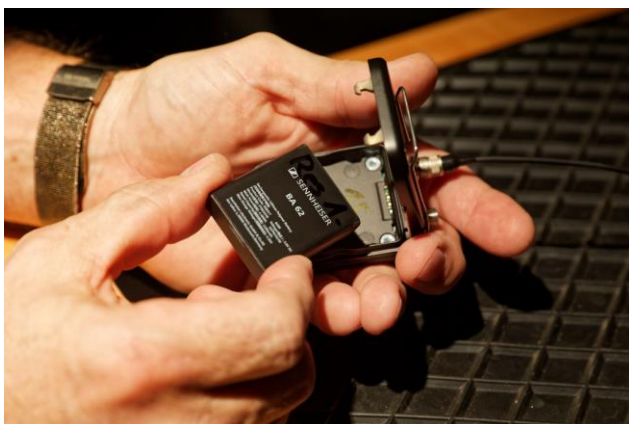
Die ultrakompakten, mit einem Gewicht von lediglich 112 Gramm bemerkenswert leichten Sennheiser SK 6212 Taschensender werden mit BA 62 Akkus betrieben
